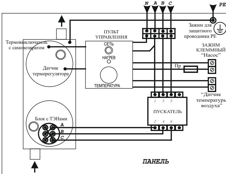
**Рисунок 6. Электрическая схема подключения**
